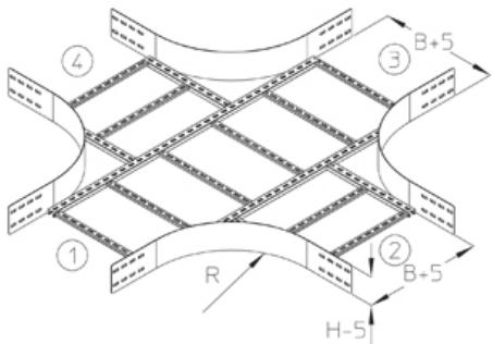
X-образный отвод, высота=100 мм
