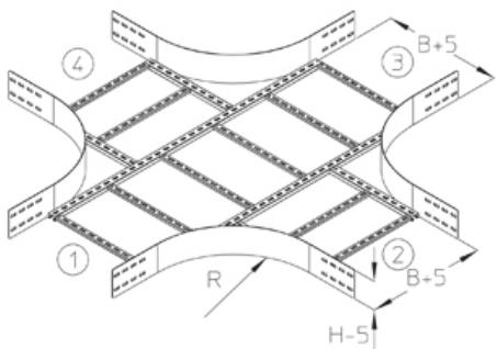
Х-образный отвод, высота=120 мм
