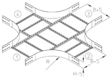
Х-образный отвод, высота=150 мм
