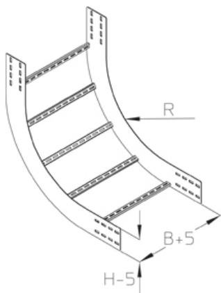
Угол вертикальный внутренний, высота=100 мм
