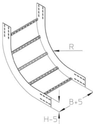
Угол вертикальный внутренний, высота=150 мм
