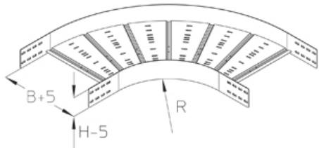
Горизонтальный угол  $90^\circ$ , предназначен для горизонтального изменения направления перфорированного лотка для больших пролётов, с интегрированными соединителями
