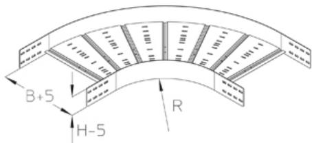
Горизонтальный угол 90°, предназначен для горизонтального изменения направления перфорированного лотка для больших пролётов, с интегрированными соединителями
