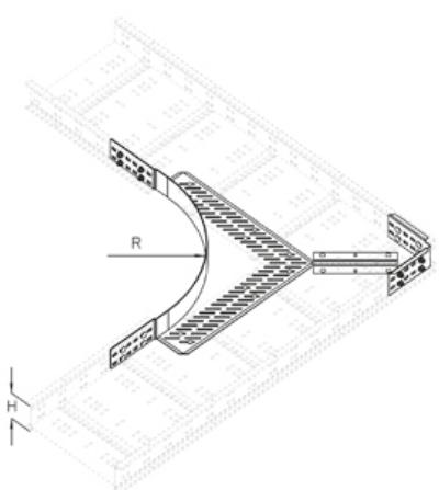
Горячекатаная методом погружения, по DIN EN ISO 1461
