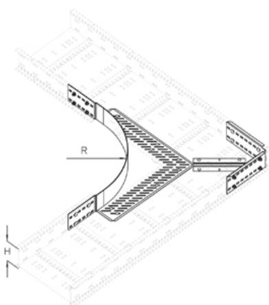
Горячекатаная методом погружения, по DIN EN ISO 1461
