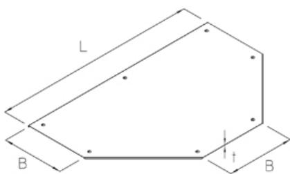
Крышка накладного ответвителя С дополнительными запорами
