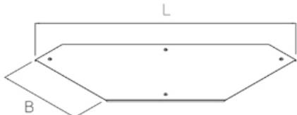
Крышка угла горизонтального С дополнительными запорами
