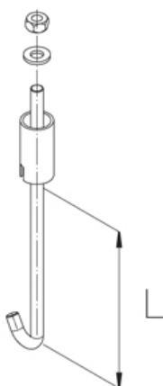
Зажим крышки на шпильке, удлиннённый, для организации большего рабочего объема лотка. Заполняемость лотка остается неизменной.
