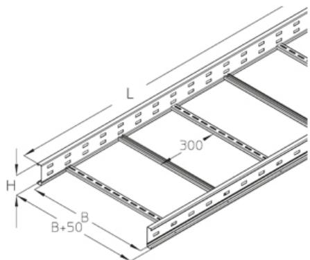
лестничный лоток для больших пролётов, высота=100 мм
