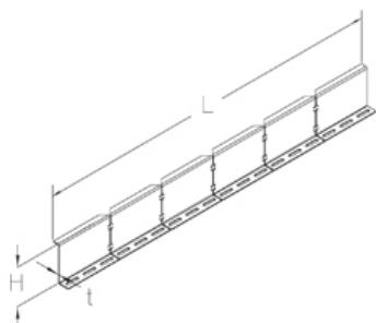
Разделитель, изменяемый, высота=100 мм
