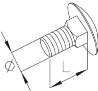
Болт с полупотайной головкой, DIN 603
