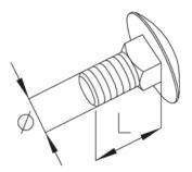
Болт с полупотайной головкой, DIN 603
