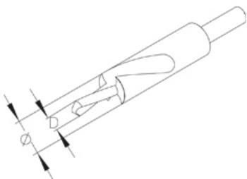
Ступенчатое сверло с плоской режущей кромкой для сверла D = 18мм
