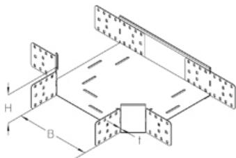
Отвод подпольного канала в виде Т-образного элемента, с интегрированными соединителями
