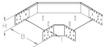
Горизонтальный угол  $90^\circ$ , предназначен для горизонтального изменения направления подпольного канала, с интегрированными соединителями
