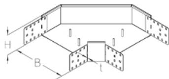
Горизонтальный угол  $90^\circ$ , предназначен для горизонтального изменения направления подпольного канала, с интегрированными соединителями
