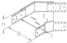
Горизонтальный угол  $45^\circ$ , предназначен для горизонтального изменения направления подпольного канала, с интегрированными соединителями
