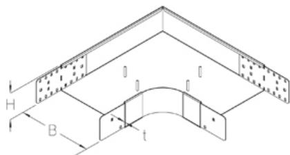
Прямой угол, скругленный, высота=100 мм
