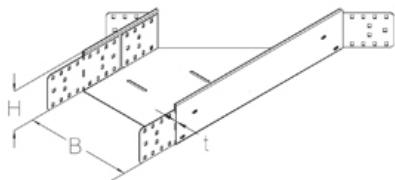
При ширине  $\geq 300$  мм необходимо установить разделитель. При ширине  $\geq 500$  мм необходимо установить два разделителя.
