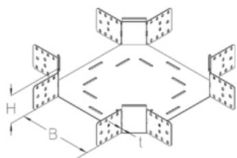
X-образный отвод, высота=110 мм
