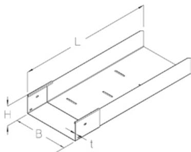
Телескопическая вставка, высота=100 мм
