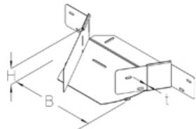
При ширине  $\geq 300$  мм необходимо установить разделитель. При ширине  $\geq 500$  мм необходимо установить два разделителя.
