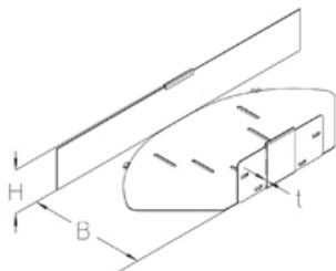
При ширине  $\geq 300$  мм необходимо установить разделитель. При ширине  $\geq 500$  мм необходимо установить два разделителя.
