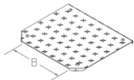
Крышка состоит из оцинкованной листовой стали толщиной 2 мм с накладкой 1 мм с противоскользящим тиснением и сопротивлением скольжению R12 согласно DIN 51130. В соответствии со спецификациями сборки и максимальным размером отсека 200 мм, испытанская грузоподъемность крышки не менее 500 кг согласно EN 50085-2-2.
