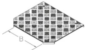
Крышка из алюминиевого рифленого листа с поворотными запорами для Т-образного отвода напольного канала.
