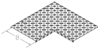
Крышка состоит из алюминиевого листа толщиной 2,5 мм с тиснением против скольжения 1,5 мм и сопротивлением скольжению R10 в соответствии с DIN 51130. В соответствии со спецификациями сборки и максимальным размером отсека 200 мм, испытанная грузоподъемность крышки не менее 500 кг согласно EN 50085-2-2.
