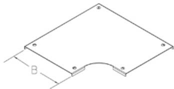
В соответствии со спецификациями сборки и максимальным размером отсека 200 мм, испытанная грузоподъемность крышки не менее 500 кг согласно EN 50085-2-2.
