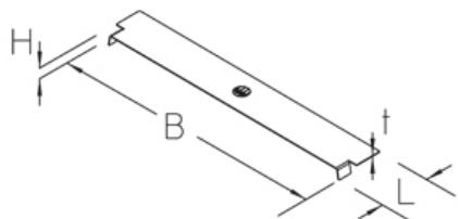
Траверса для поддержки и герметичного закрытия стыков крышек
