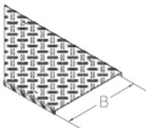
Крышка состоит из алюминиевого листа толщиной 2,5 мм с тиснением против скольжения 1,5 мм и сопротивлением скольжению R10 в соответствии с DIN 51130. В соответствии со спецификациями сборки и максимальным размером отсека 200 мм, испытанная грузоподъемность крышки не менее 500 кг согласно EN 50085-2-2.
