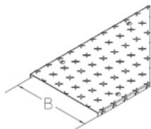
Крышка состоит из оцинкованной листовой стали толщиной 2 мм с накладкой 1 мм с противоскользящим тиснением и сопротивлением скольжению R12 согласно DIN 51130. В соответствии со спецификациями сборки и максимальным размером отсека 200 мм, испытанская грузоподъемность крышки не менее 500 кг согласно EN 50085-2-2.
