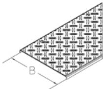
Крышка состоит из оцинкованной листовой стали толщиной 2 мм с накладкой из алюминиевого листа с противоскользящим тиснением и сопротивлением скольжению R10 согласно DIN 51130. В соответствии со спецификациями сборки и максимальным размером отсека 200 мм, испытанская грузоподъемность крышки не менее 500 кг согласно EN 50085-2-2.
