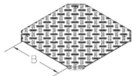
Крышка из алюминиевого рифленого листа с поворотными запорами для X-образного отвода напольного канала.
