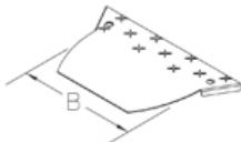
Крышка состоит из оцинкованной листовой стали толщиной 2 мм с накладкой 1 мм с противоскользящим тиснением и сопротивлением скольжению R12 согласно DIN 51130. В соответствии со спецификациями сборки и максимальным размером отсека 200 мм, испытанская грузоподъемность крышки не менее 500 кг согласно EN 50085-2-2.
