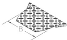
Крышка состоит из алюминиевого листа толщиной 2,5 мм с тиснением против скольжения 1,5 мм и сопротивлением скольжению R10 в соответствии с DIN 51130. В соответствии со спецификациями сборки и максимальным размером отсека 200 мм, испытанная грузоподъемность крышки не менее 500 кг согласно EN 50085-2-2.
