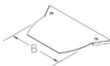
В соответствии со спецификациями сборки и максимальным размером отсека 200 мм, испытанная грузоподъемность крышки не менее 500 кг согласно EN 50085-2-2.
