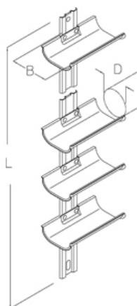
Поддержка кабеля проходная, диаметр 100 мм
