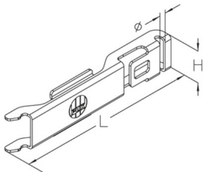
Используется с U-образным проволочным лотком с шагом сетки 100 мм. Универсальное использование защелкивающегося соединителя для боковых или напольных соединений. Безвинтовая монтаж / демонтаж. Беззазорные версии для проволоки Ø4 мм и Ø4,5 мм.
