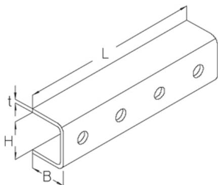
Горячеоцинкованная методом погружения, по DIN EN ISO 1461
