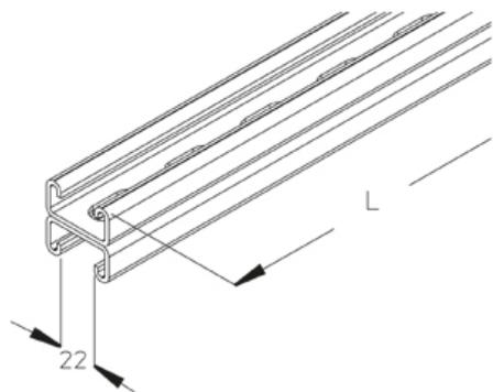
С-профиль 40x42x2.50 мм, размер перфорации 14x30, соединён спина к спине, ширина шлица 22 мм
