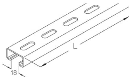
С-профиль 39.5x22x1.50 мм, размер перфорации 11x30, ширина шлица 18 мм
