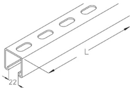
С-профиль 40x41x1.50 мм, размер перфорации 14x30, ширина шлица 22 мм
