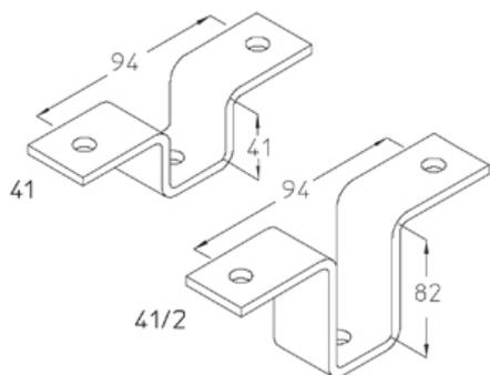
Горячеоцинкованная методом погружения, по DIN EN ISO 1461
