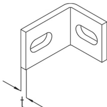
Крепежный уголок для монтажа профилей КНУ 40/57/60 и КНА к стене
