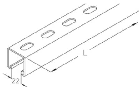
С-профиль 40x41x2.50 мм, размер перфорации 14x30, ширина шлица 22 мм
