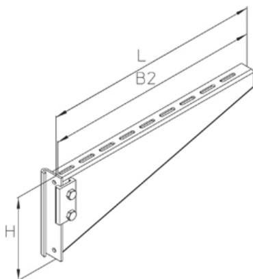
Горячеоцинкованная методом погружения, по DIN EN ISO 1461
