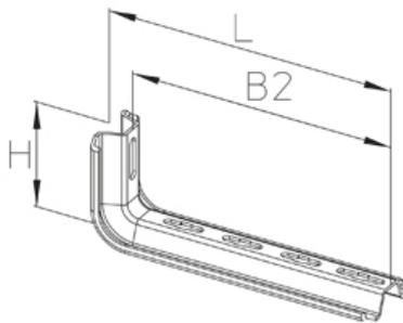
Универсальная консоль, для легких нагрузок, из трапецевидного профиля 60x20 мм, перфорированная посередине. Протестировано в соответствии с DIN EN 61537. Для крепления к потолочной консоли KDSL. Расстояние между опорами макс. 1,2 м.
