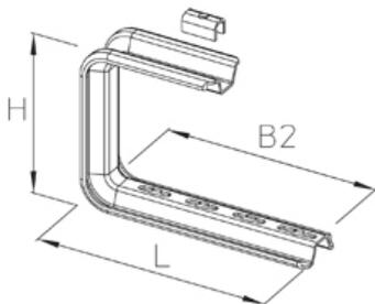
Потолочная консоль, для легких нагрузок, из трапециевидного профиля 60x20x2.5 мм, перфорированная посередине, высота подвеса = 170 мм
